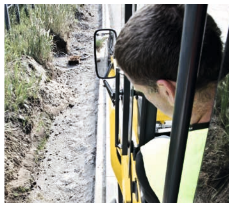
Створчатое окно и сдвигающееся сиденье обеспечивают комфортную работу.
