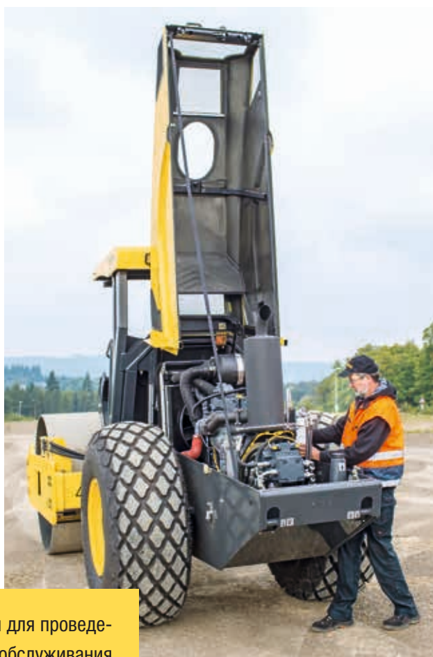
Простота обслуживания – у грунтовых катков 40-й серии нет смазочных ниппелей.
