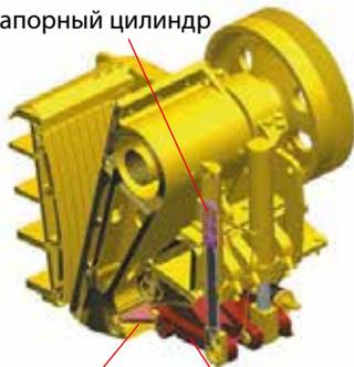
Соединительная пластина    Неподвижный шарнир
